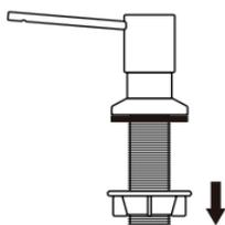
**2-** Insira o tubo do pump no sistema pump, por dentro da rosca, e passe pela bancada.
