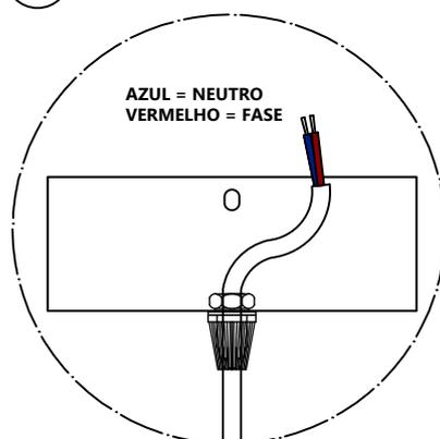
Conecte o fio fase e o fio neutro na rede elétrica.
