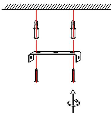
Fixe a travessa no teto utilizando buchas e parafusos (**NÃO ACOMPANHAM O PRODUTO**) para gesso ou alvenaria.
