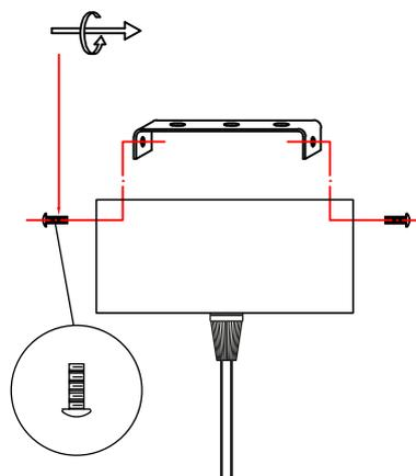
Encaixe a base na travessa e fixe-a utilizando os parafusos correspondentes.
