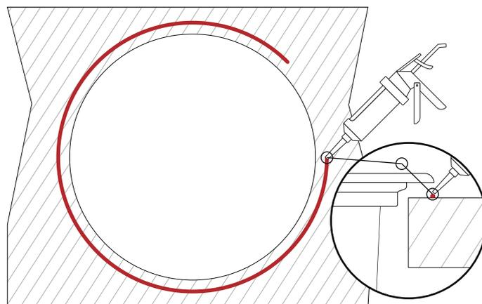
**3-** Fixe o acabamento na bancada e limpe o excesso de silicone PU com uma lâmina ou estilete, em seguida limpe a região em volta com uma flanela macia e álcool.
