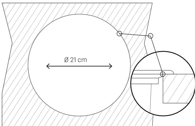
**2-** Passe o silicone PU entre a pedra e a borda do acabamento, para vedar a passagem de água e evitar que ocorram infiltrações dentro do móvel.
