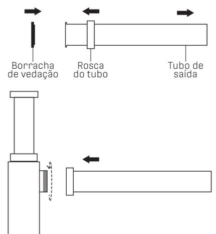
**4-** Passe o acabamento pelo tubo de saída e o encaixe no ponto de esgoto. Caso a saída seja padrão DN40, utilize o adaptador para vedar a saída.
