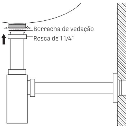
**6-** Para limpeza interna do copo, desrosqueie a rosca de 1 1/4" da válvula e a rosca do tubo de saída e em seguida puxe o tubo de entrada. Faça a limpeza e recolque-os novamente.
