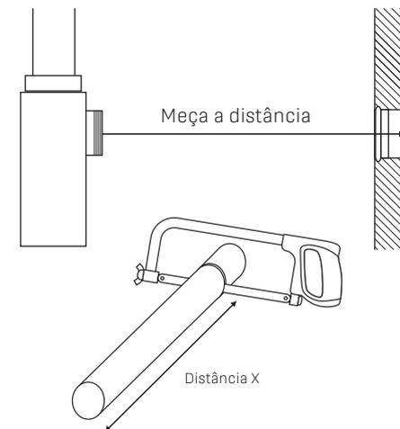
**3-** Desrosqueie o sifão da válvula de escoamento. Passe o tubo de saída pela rosca, encaixe a borracha de vedação e então rosqueie no sifão.
