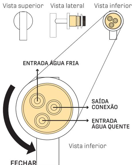
**2- Instale as mangueiras no monocomando progressivo, seguindo a ordem abaixo: Passe pela porca, rosca e borracha de vedação, em seguida passe pela bancada e pela segunda borracha de vedação.**
