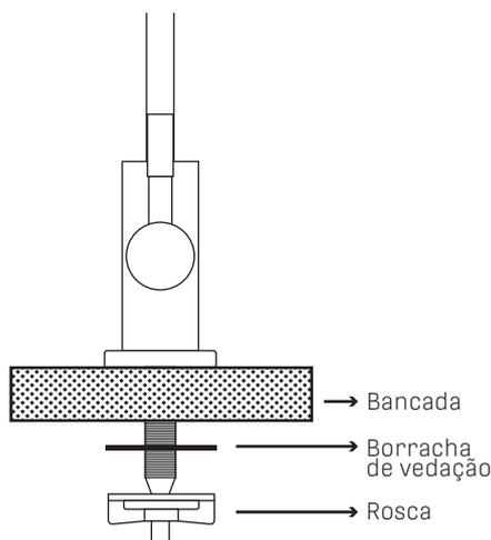
**2-** Retire as travas azuis do engate rápido 1/4". Encaixe um lado no final da rosca da torneira e o outro lado na mangueira. Depois, encaixe as travas novamente.
