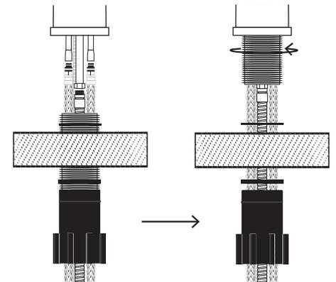
**4-** Fixe a torneira na bancada e as mangueiras na parede utilizando nípeis.
