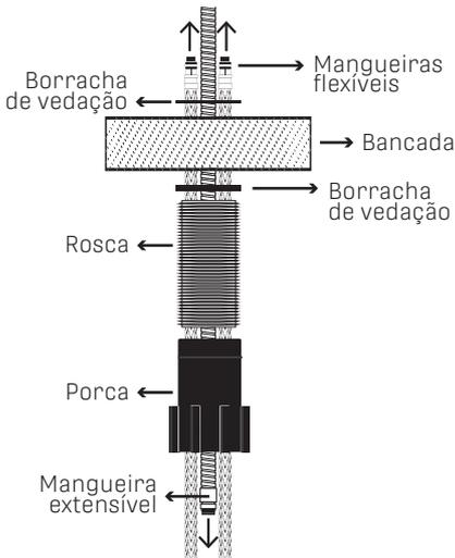
**2-** Passe a ponta da mangueira extensível para cima, deixando a volta para baixo da bancada.
