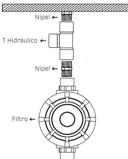
**5- Utilizando nípeis, fixe a mangueira de água quente na saída de água quente da parede e a mangueira de água fria no T Hidráulico.**
