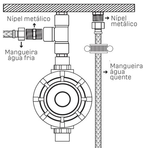
**6- Fixe a mangueira para água filtrada (25 cm) no filtro utilizando um nípel, ou o adaptador para mangueiras de 3/8", dependendo o modelo do filtro.**
