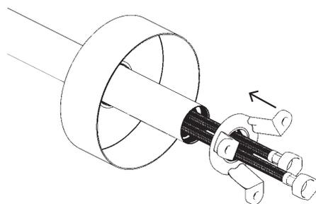
3 - Conecte as Mangueiras flexíveis (7), no Corpo da torneira (2), Após instaladas as Mangueiras, rosqueie a Coluna (1) no Corpo da torneira (2).
