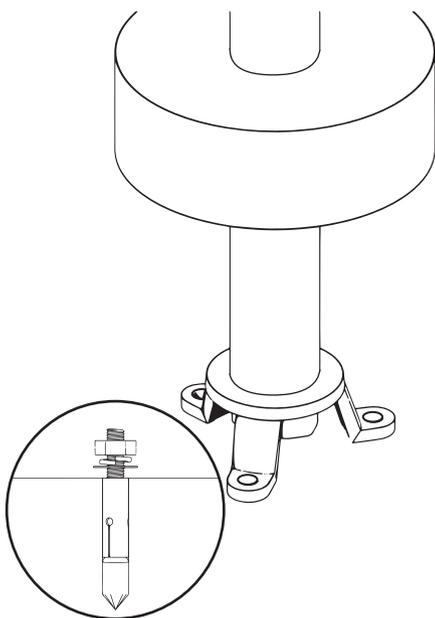
5 - Encaixe a Base de fixação da Coluna (5) nos parafusos instalados, recoloca as arruelas na sequencia da imagem: Arruela, arruela de pressão e porca.
