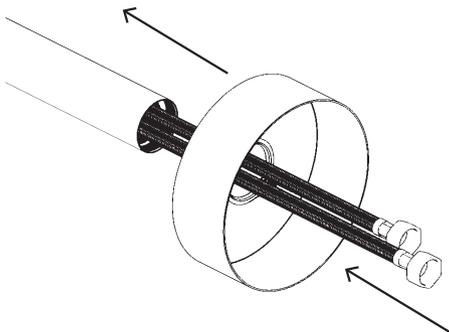
2 - Passe as porcas das Mangueiras flexíveis (7) pela Base de fixação da Coluna (5) e rosqueie a Coluna na Base.
